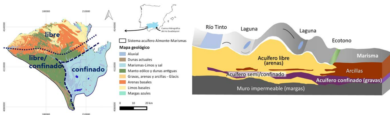
Figura 2. Descripción gráfica del sistema acuífero Almonte-Marismas y de su funcionamiento como acuífero libre o confinado (Fuente: elaboración propia). En la imagen de abajo, se presenta un corte hidrogeológico de este (derecha) a oeste (izquierda).
